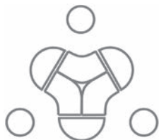
Configuration à trois faces Trois modules courbes 120 degrés, trois modules demi-cercle et trois modules circulaires
